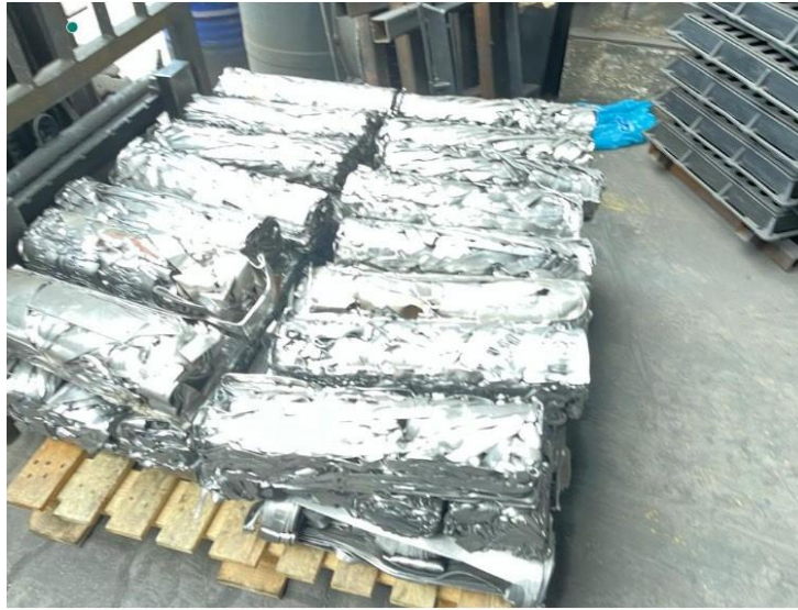
Figura 5. Material compactado, limpio de impurezas preparado para ser fundido.
