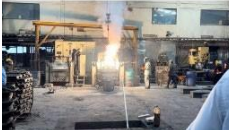
Figura 7. Fusión del metal en el horno, en este caso la temperatura de fusión fue de 1400 °C
