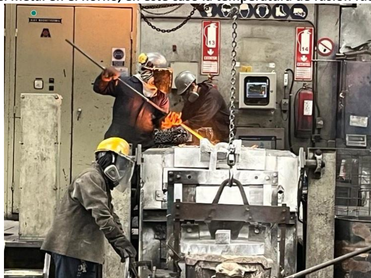
Figura 8. Toma de la muestra del material fundido para ser examinado en el laboratorio.
